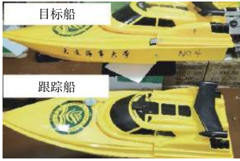
图 4 目标跟踪无人艇试验平台
